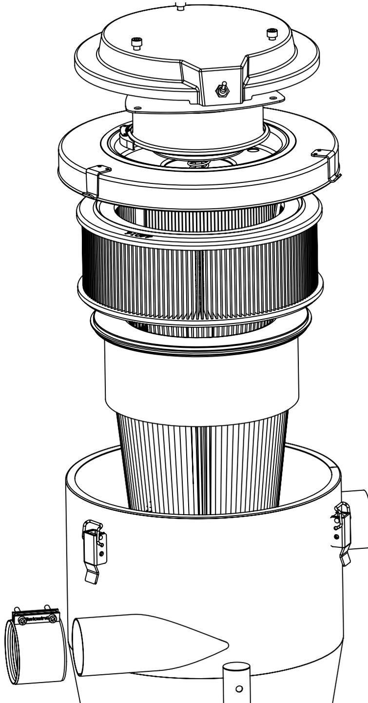
Aseta mikrosuodatin paikalleen levyn keskelle. Tarkista pyörittämällä suodatinta, että tiiviste asettuu tasaisesti osia vasten.
